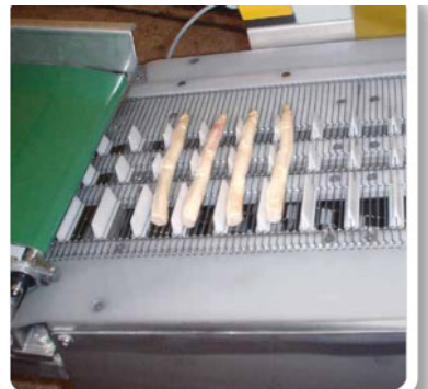
Stabgeflechtband mit einzelnen Mitnehmern im Betrieb (Wasch- und Schneideanlage für Spargel)
