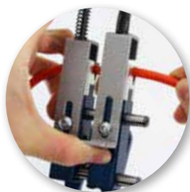
Schnellspanvorrichtung zum Einlegen der Riemen in austauschbare Backen.
