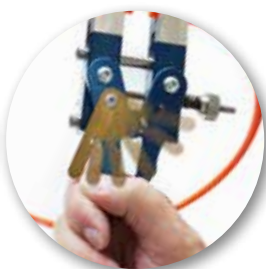
Automatische Entriegelung startet seitlichen Anpressdruck.
