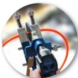
Präzises Verschweißen dank gleichbleibendem Anpressdruck.
